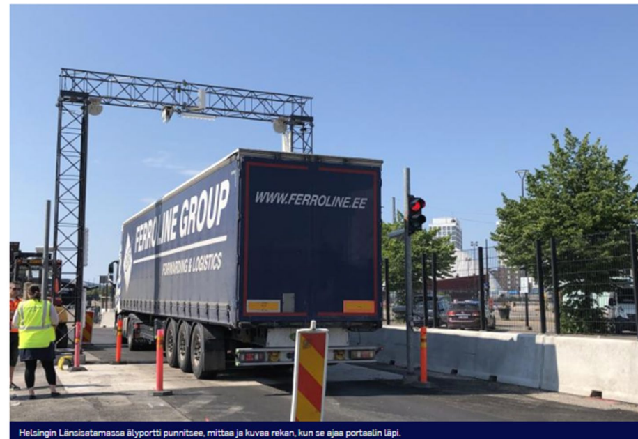
Helsingin Länsisatamassa älyportti punnitsee, mittaa ja kuvaa rekan, kun se ajaa porttaalin läpi.
